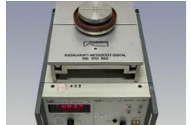
Radialkraftmessung eines Radial-Wellendichtrings
